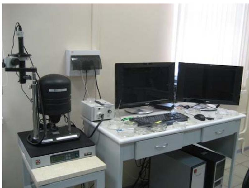
Рисунок 2.2 – Внешний вид сканирующего зондового микроскопа Solver Pro фирмы НТ МДТ
