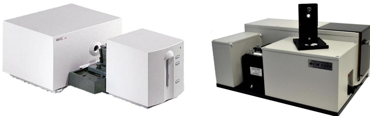
Рисунок 27. Слева – спектрофотометр Agilent 8453, справа – ИК фурье-спектрометр Инфраспек ФСМ 1201.
