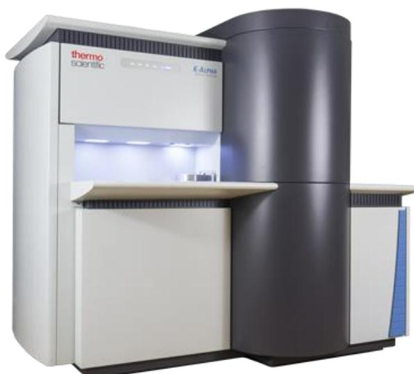
Рисунок 21. Рентгеновский фотоэлектронный спектрометр Thermo Fisher Scientific K-ALPHA.
