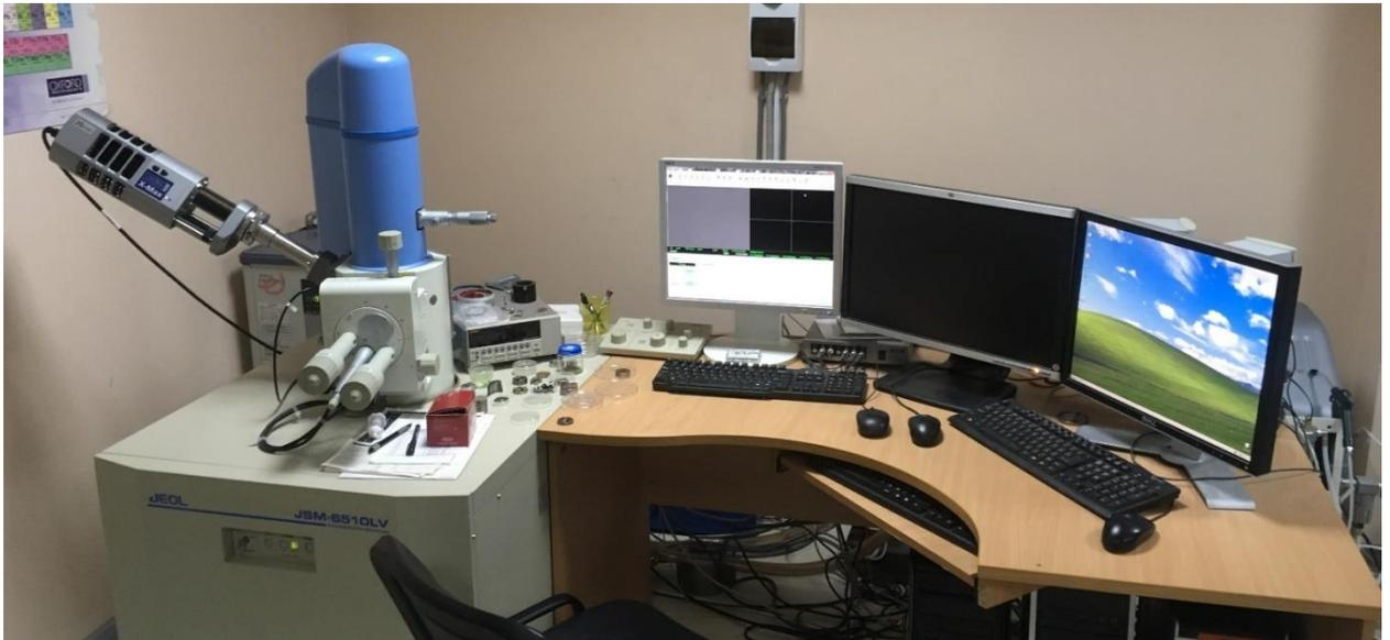
Рисунок 19. Сканирующий электронный микроскоп JEOL JSM-6510 LV с энергодисперсионной приставкой Oxford Instruments X-Max 20 mm<sup>2</sup>.
