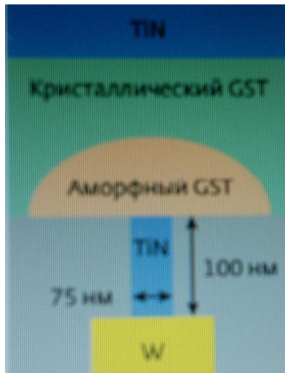
Рис. 22. Коммутирующая ячейка на основе GeSbTe
