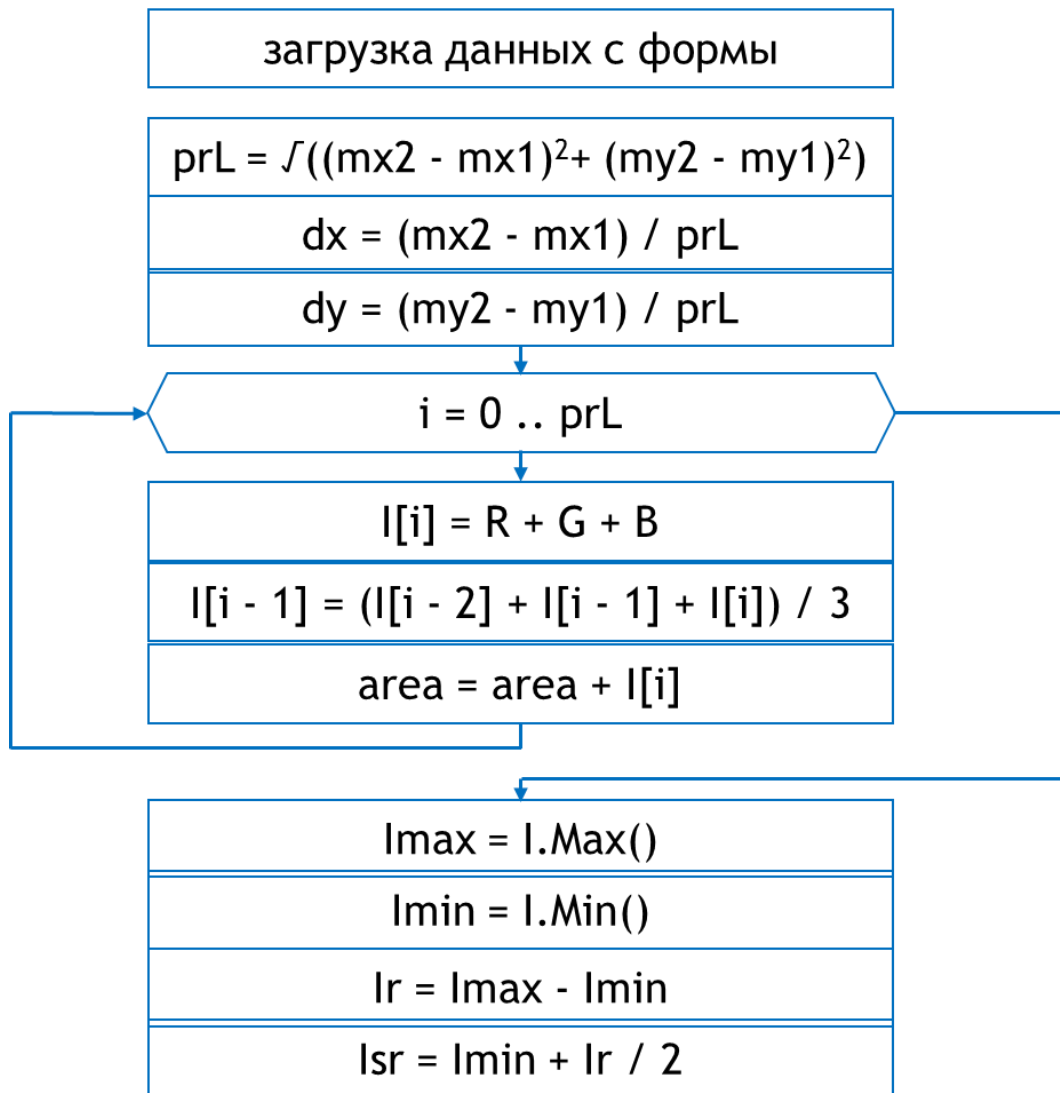
Рис. 9. Алгоритм построения профиля дифракционного рефлекса и измерения его параметров.
