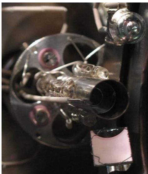
Рис. 2.2. Электронная пушка для формирования первичного пучка с энергией 10...4000 эВ.
