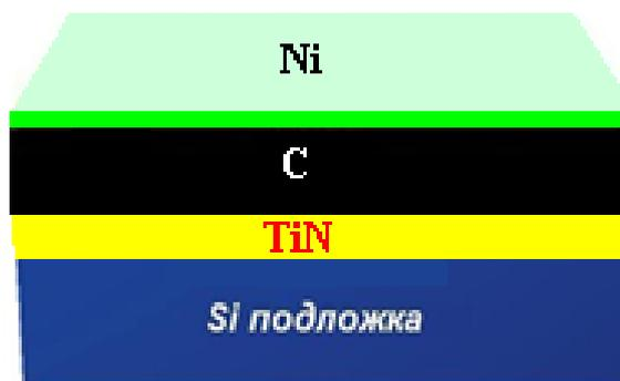
Рисунок 40 – Схема структуры Si/TiN/C/Ni
