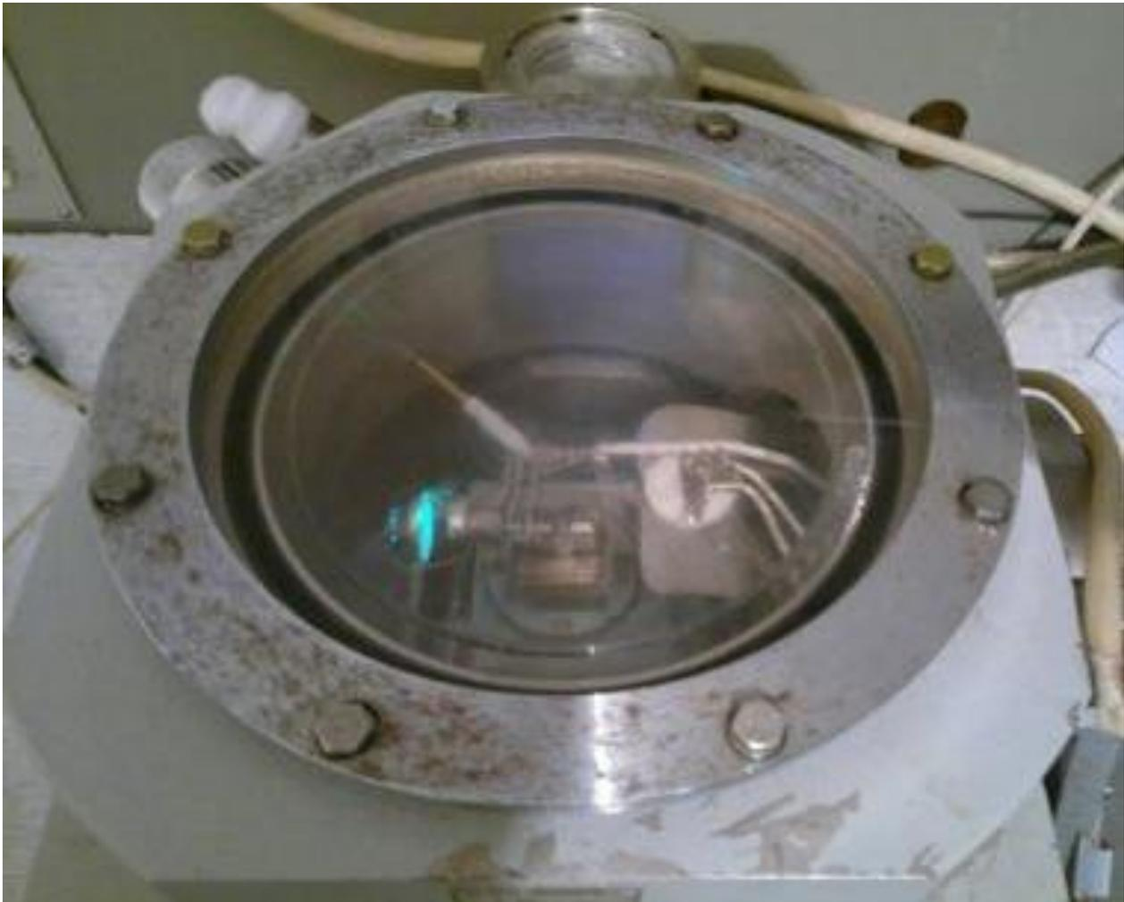
Рисунок 21 – Макет катодолюминесцентного источника света
