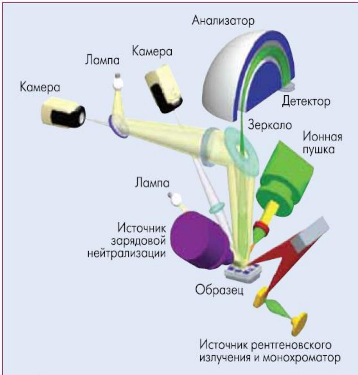
Рисунок 24 – Архитектура установки РФЭС-системы K-Alpha
