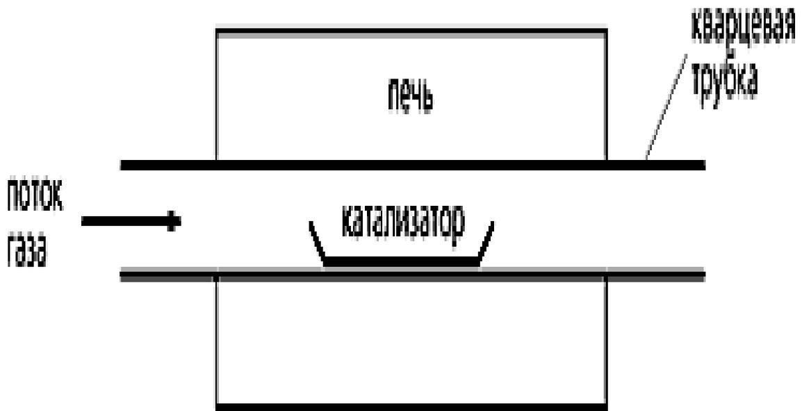
Рисунок 6 – Схема получения УНТ методом химического осаждения из пара
