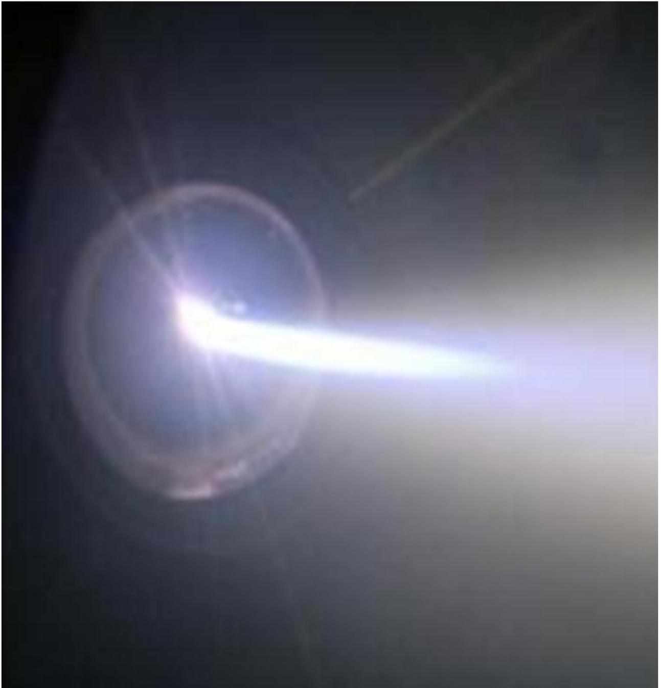
Рисунок 15 – Фотография пучка ионов С в магнитном поле
