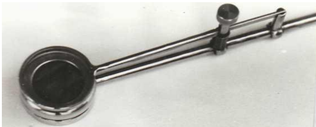
Рис. 1.1. Устройство М. З. Сигала и А. И. Лисина [160] для измерения кровяного давления в интрамуральных сосудах полых органов.
