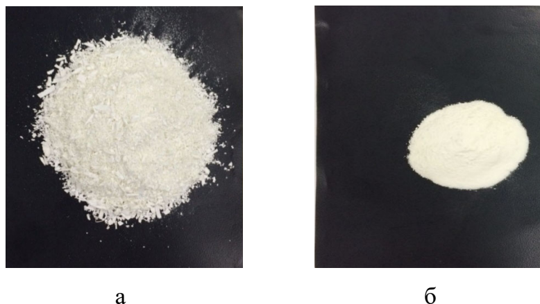
Рисунок 47 – Снимки некапсулированного (а) и капсулированного (б) образцов ПЭЭК (I) массами по 5 г
