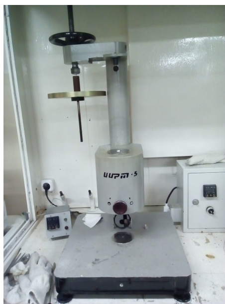
Рисунок 24 – Прибор для определения показателя текучести расплава ИИРТ-5 (Россия)
