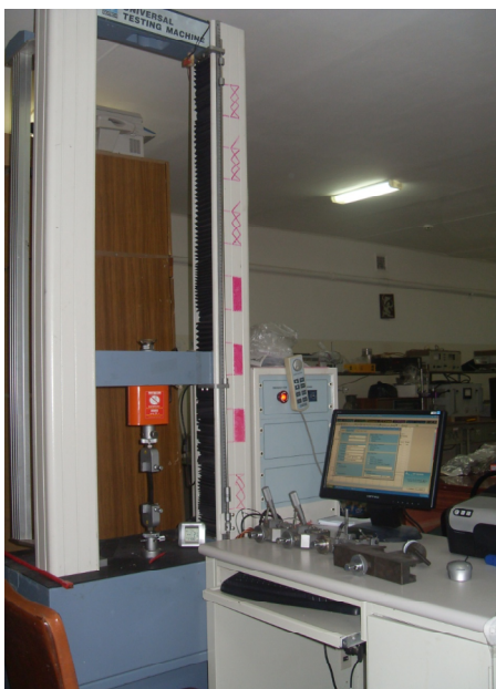
Рисунок 22 – Разрывная машина GT-TCS 2000 Gotech Testing Machines Inc. (Тайвань)
