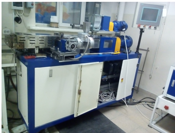
Рисунок 20 – Двухшнековый экструдер Clam-Sheel Barrel Twin Screw Extruder Jiangsu Xinda Science and Technology Co., Ltd (Китай)
