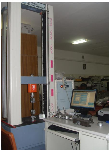
Рисунок 22 – Разрывная машина GT-TCS 2000 Gotech Testing Machines Inc. (Тайвань)
