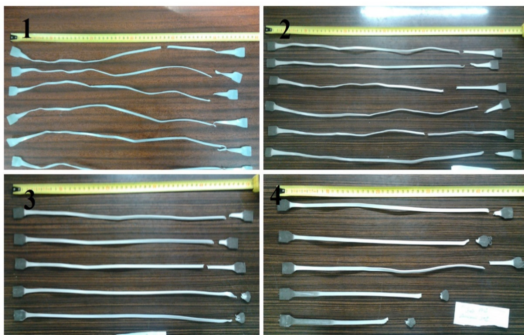
Рисунок 19 – Изображения испытанных образцов с различными концентрациями диатомита: 1 – 100 % СЭБГП; 2 – 90 % СЭБГП + 10 % диатомита; 3 – 80 % СЭБГП + 20 % диатомита; 4 – 30 % СЭБГП + 30 % диатомита
