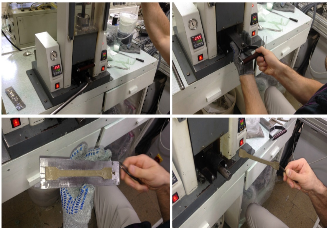
Рисунок 15 – Приготовление образцов для определения механических характеристик
