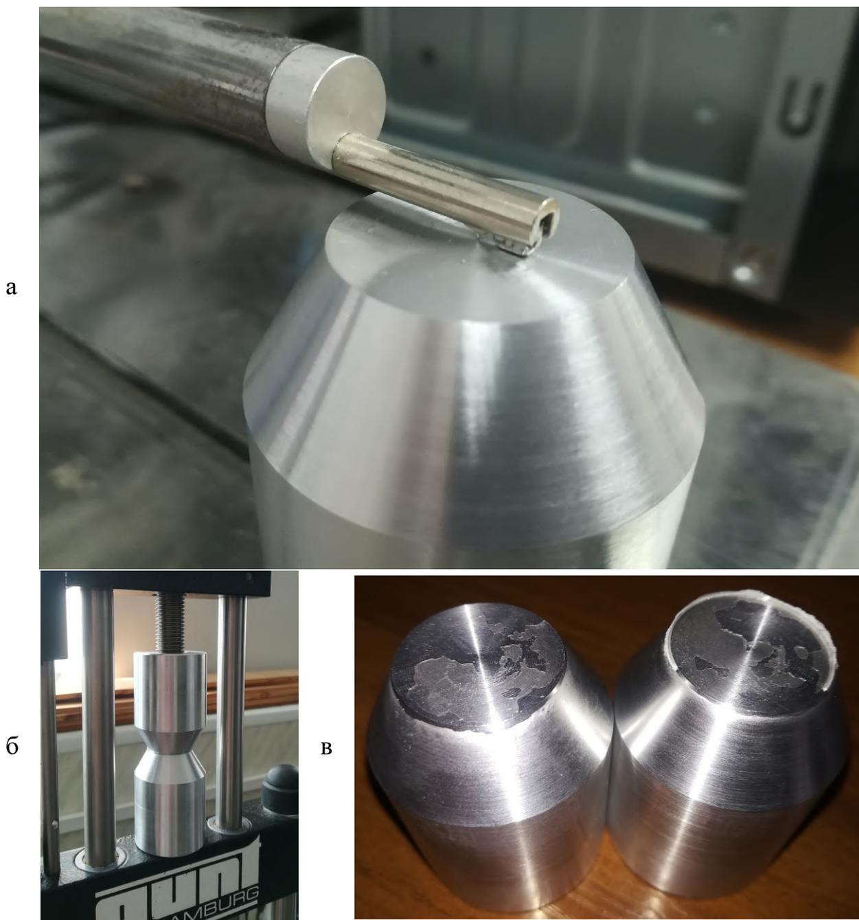
Рис. 18. Испытания на адгезионный отрыв: оценка шероховатости алюминиевых образцов (а); универсальная испытательная машина WP300 (б) и результат проведения эксперимента — адгезионное разрушение на поверхности алюминиевых образцов (в)
