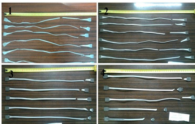
Рисунок 3 – Изображения испытанных образцов с различными концентрациями диатомита: 1 – 100 % СЭБГП; 2 – 90 % СЭБГП + 10 % диатомита; 3 – 80 % СЭБГП + 20 % диатомита; 4 – 30 % СЭБГП + 30 % диатомита
