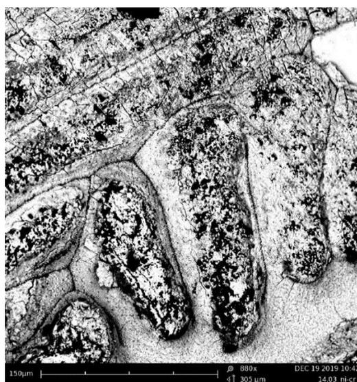
Рисунок 4.10 – Морфология поверхности подложки из Ni-Cr после контакта с расплавом Pb-0,214 ат.% Na (увеличение 880 раз).
