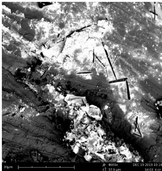
Рисунок 4.7 – Морфология поверхности подложки из Co-Cr после контакта с расплавом Pb-0,214 ат.% Na (увеличение 4600 раз).
