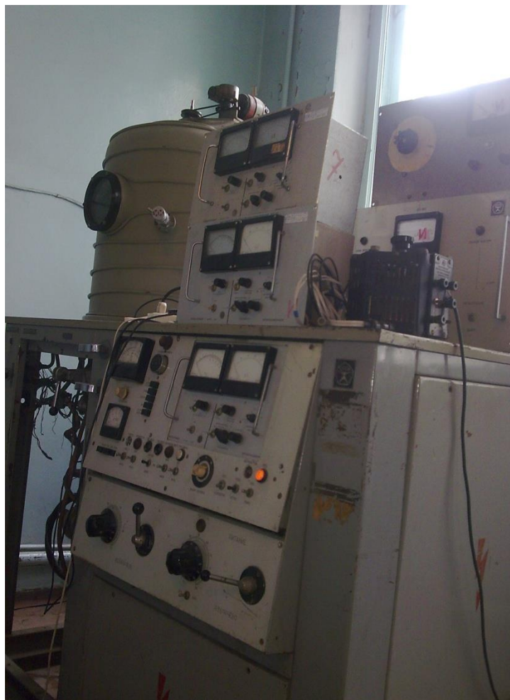
Рисунок 2.2. Установка УВМ-3М для напыления тонких металлических пленок на диэлектрические подложки.
