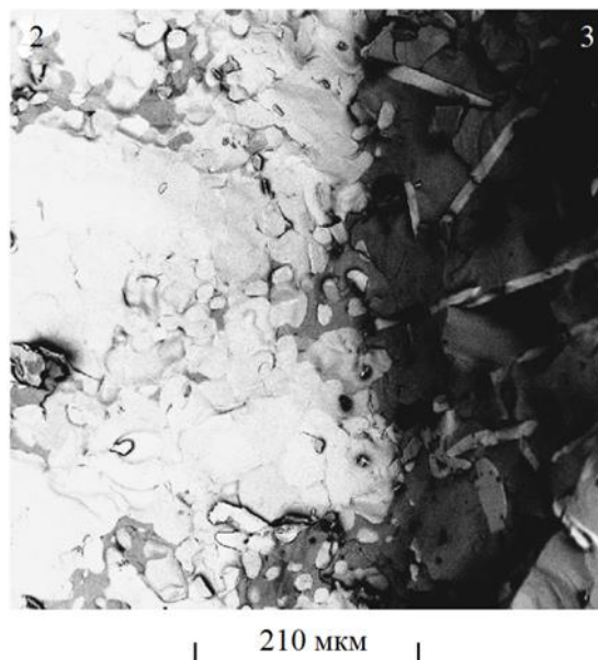
Рисунок 3.2. Микрофотография границы раздела двух разнородных фаз в контактной прослойке Al–Cu. Увеличение \times 560 раз.
