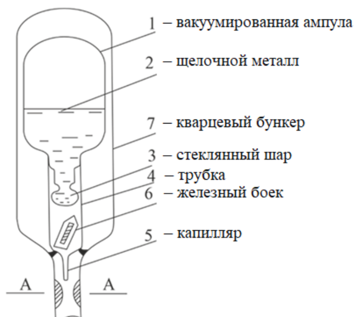
Рисунок 6 – Устройство для загрузки щелочных металлов в измерительную ячейку
