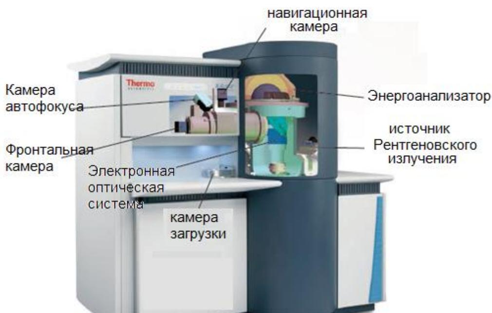
Рисунок 2.2 – спектрометр K-alpha Thermo Scientific и его устройство
