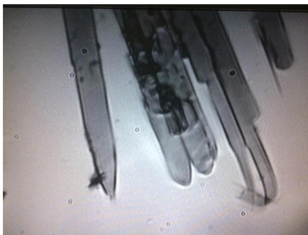
Рисунок 2.15 – Микрофотография игольчатых монокристаллов  $\text{MoO}_3$ , средний эффективный диаметр иголок составляет  $\sim 10$  мкм.
