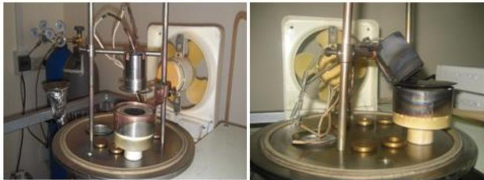
Рис. 2.3. Виды подколпачной системы с различными расположениями основных узлов магнетронной системы распыления
