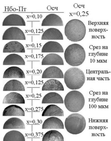
Рисунок 2 – Отшлифованные поверхности спечённых керамик в зависимости от состава и квалификации, используемого сырья (слева), срезы керамического образца квалификации «Осч» на различной глубине (справа)
