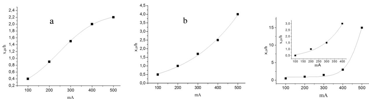
Рис. 1. Зависимость скорости роста от тока разряда при распылении мишеней YBa<sub>2</sub>Cu<sub>3</sub>O<sub>7-δ</sub>, изготовленных: а) по обычной керамической технологии; б) с добавкой 20% нанопорошка; в) из плотной наноструктурированной керамики.
