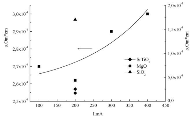
Рис. 13. Зависимость  $\rho$  пленок от тока разряда ( $T=300K$ ), полученных на  $Si$  (■) и для сравнения на  $SrTiO_2$ ,  $MgO$  и  $SiO_2$  подложках.
