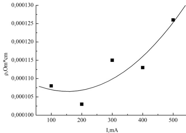
Рис.5. Значения электросопротивления пленок  $\text{Si}/\text{YBa}_2\text{Cu}_3\text{O}_{7-\delta}$  ( $\text{Ag}/\text{O}_2$ ) при комнатной температуре в зависимости от тока разряда.
