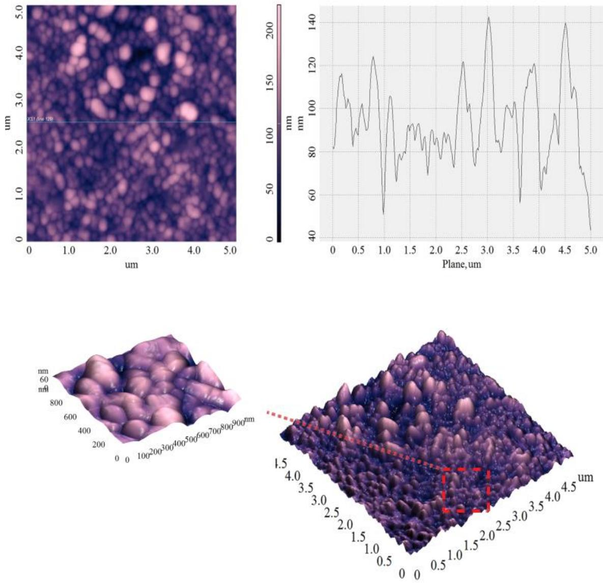
Рис. 11 Сканы морфологии пленки  $\text{YBa}_2\text{Cu}_3\text{O}_{7-\delta}$ , полученной на кремнии.
