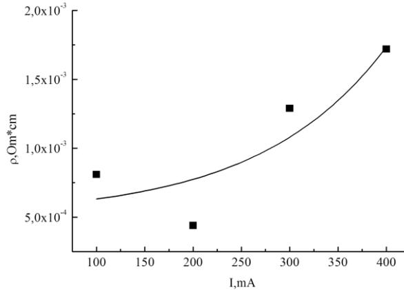
Рис. 9. Электросопротивления пленок  $\text{YBa}_2\text{Cu}_3\text{O}_{7-\delta}$  на кремниевых подложках при комнатной температуре в зависимости от тока разряда
