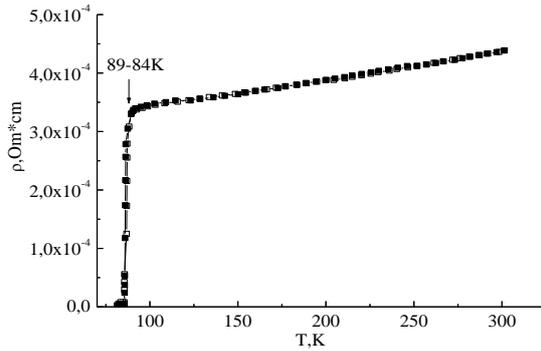
Рис. 7. Зависимость  $\rho=f(T)$  пленки  $\text{YBa}_2\text{Cu}_3\text{O}_{7-\delta}$ , ток разряда 200 мА (наноструктурированная мишень).
