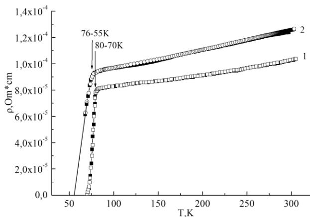
Рис.4. Зависимости  $\rho=f(T)$  пленок  $\text{Si}/\text{YBa}_2\text{Cu}_3\text{O}_{7-\delta}$  ( $\text{Ar}/\text{O}_2$ ) при токах разряда: 1 –  $200\text{ mA}$ ; 2 –  $500\text{ mA}$
