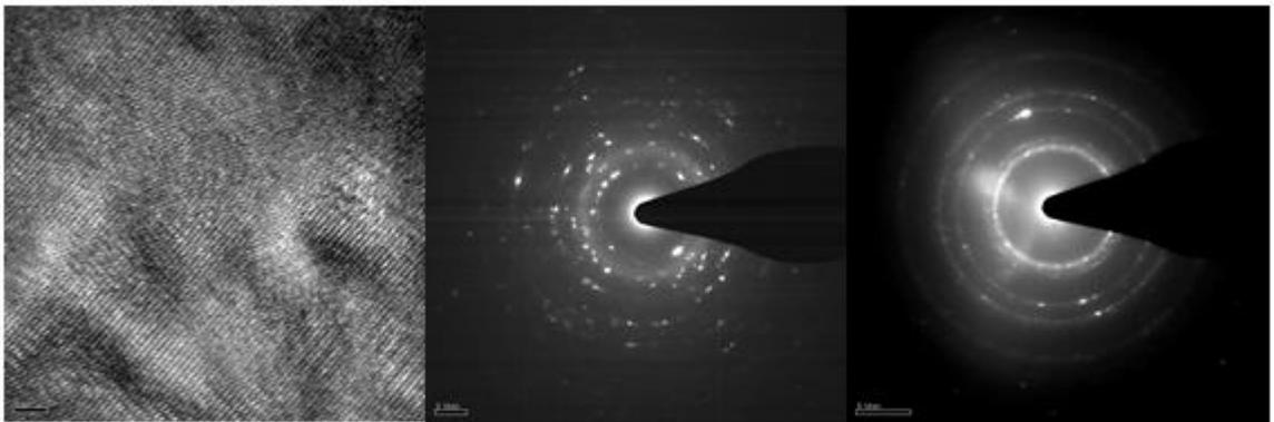
Рис.10. Морфология пленки полученной распылением микрокристаллической мишени  $\text{YBa}_2\text{Cu}_3\text{O}_{7-\delta}$  и электронограммы этой пленки: при большом – слева и меньшем – справа разрешениях.
