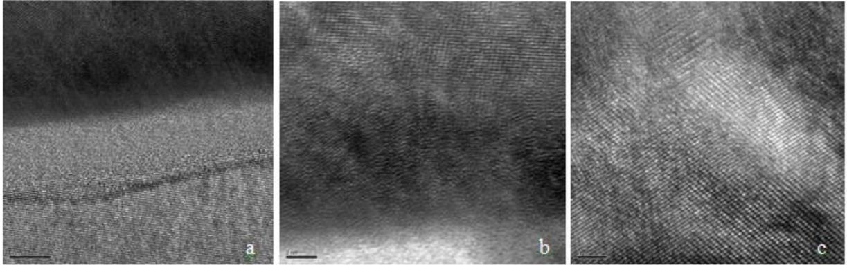
Рис. 6. Морфология пленки полученной распылением наноструктурированной мишени: а) снизу вверх – кремниевая подложка, окисная пленка на ней и пленка  $\text{YBa}_2\text{Cu}_3\text{O}_{7-\delta}$ ; б) пленка выше оксидного слоя; в) пленка  $\text{YBa}_2\text{Cu}_3\text{O}_{7-\delta}$
