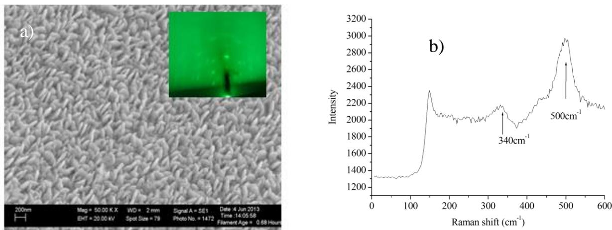
Рис.3. Морфология - а) и спектр КР - б) пленки  $\text{Si}/\text{YBa}_2\text{Cu}_3\text{O}_{7-\delta}$ , полученной в смеси  $\text{Ar}/50\%\text{O}_2$ . на вставке а) - электронограмма этой пленки.
