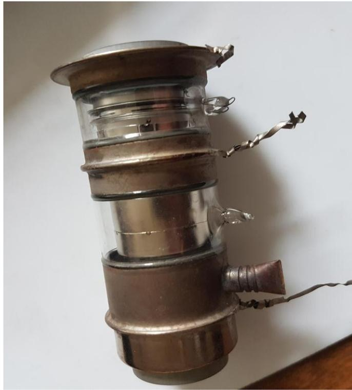
Рисунок 3.6. – Фотография вакуумированного макета ЭОП для исследования неустойчивости коэффициента усиления МКП.
