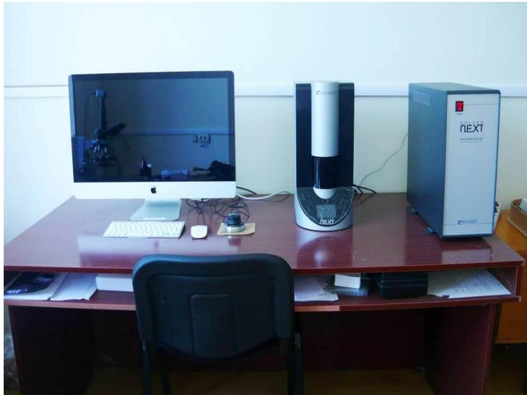
Рисунок 2.1. – Фотография атомно-силового микроскопа SOLVER NEXT.
