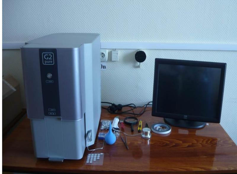
Рисунок 2.2. – Внешний вид микроскопа «PHENOM».
