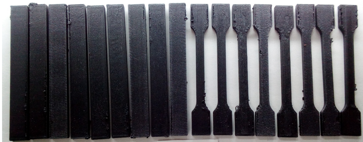
Рисунок 47 – Напечатанные образцы: ПФС н УВ + ОФС н
