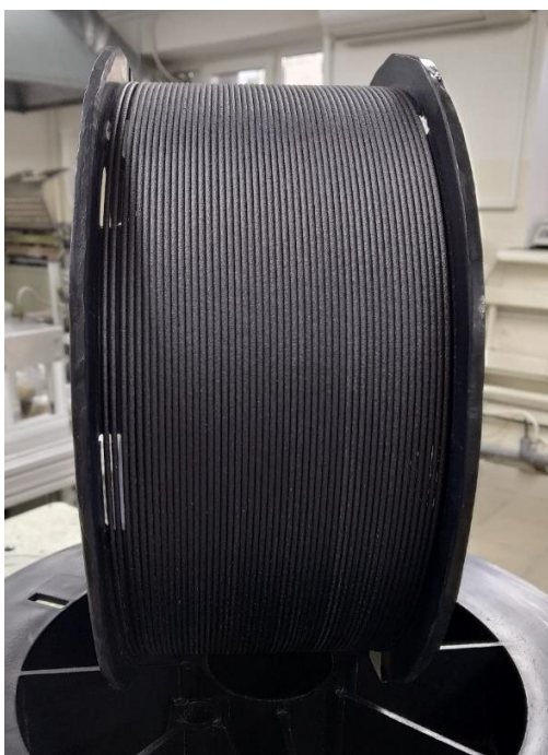
Рисунок 46 – Образцы высоконаполненных филаментов: ПФС н УВ + ОФС н (а) и ПФС н СВ + ОФС н (б)
