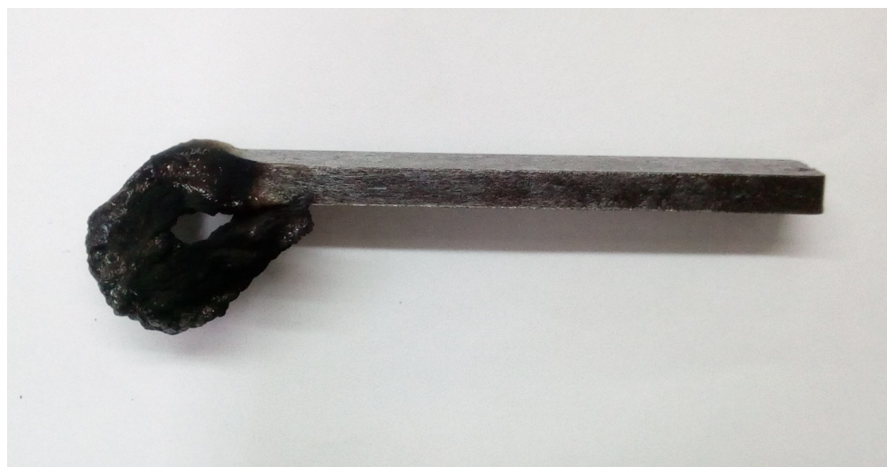
Рисунок 23 – Фотография брусков ПФСн + 30 % УВ 0,2 мм (а) и ПФСн + 30 % СВ 0,2 мм (б) после испытания
