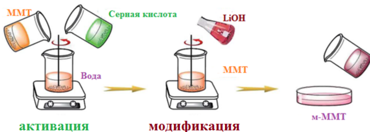
Рисунок 10 – Схема активации и модификации ММТ
