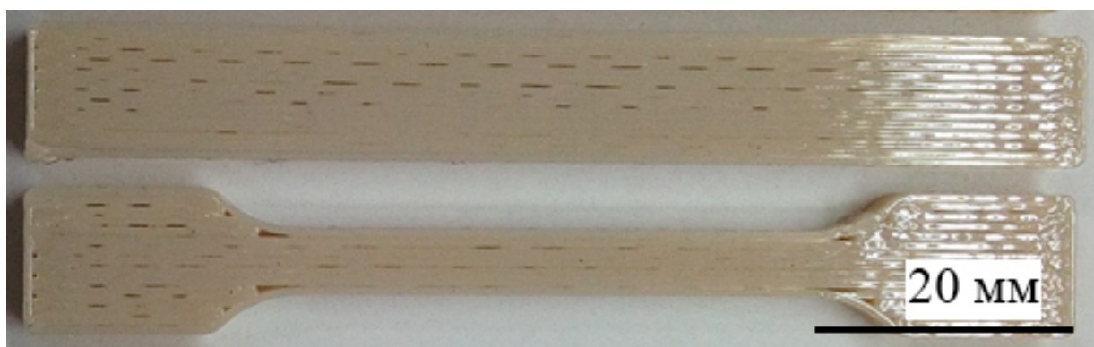
Рисунок 64 – Фото образцов, напечатанных при высоте слоя 0,3302 мм и ширине 0,8 мм
