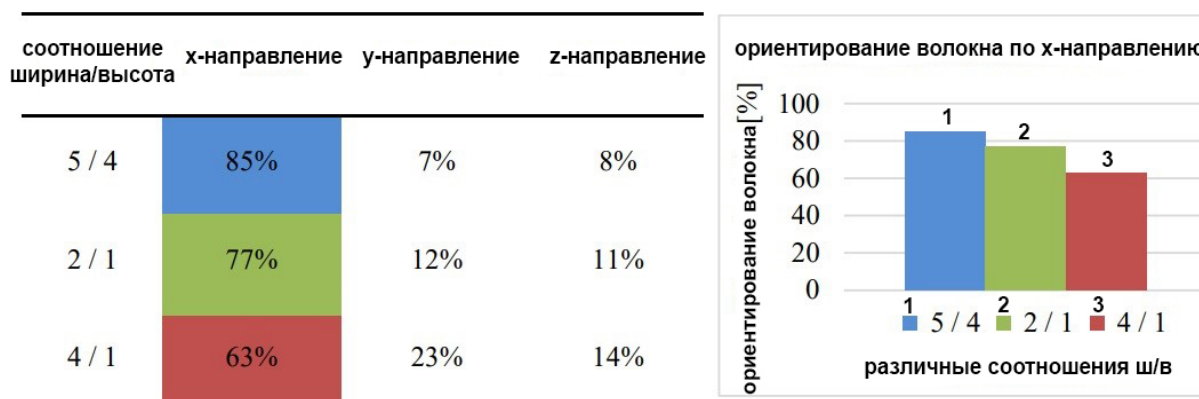
Рисунок 11 – Ориентирование рубленных углеродных волокон в расплаве полимера при FDM печати в зависимости от отношения ширины слоя к высоте слоя
