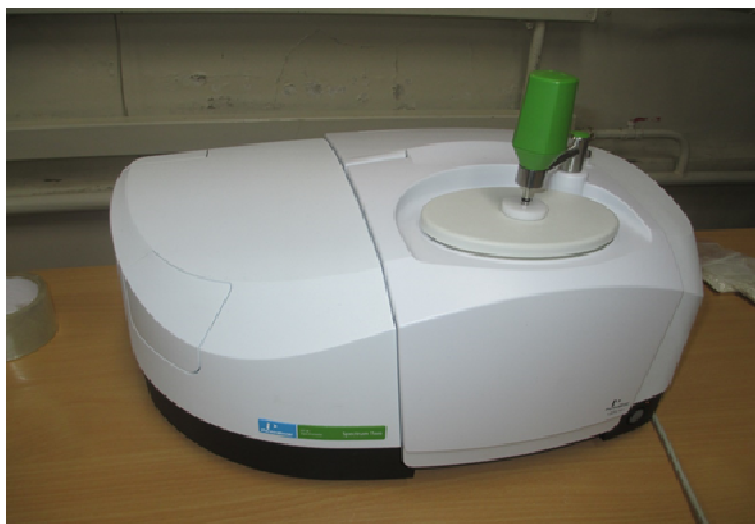
Рисунок 18 – ИК-спектрометр «SPECTRUM TWO» фирмы Perkin Elmer
