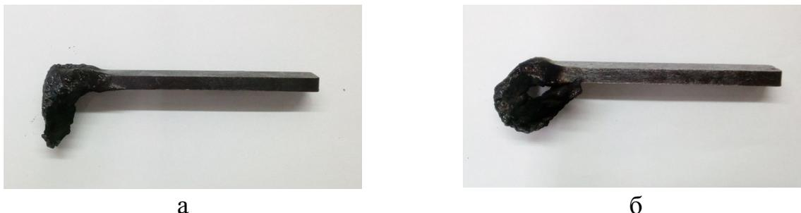
Рисунок 2 – Образцы композитов после испытания на огнестойкость: ПФСн + 30 % УВ 0,2 мм (а); ПФСн+30 % СВ 0,2 мм (б)
