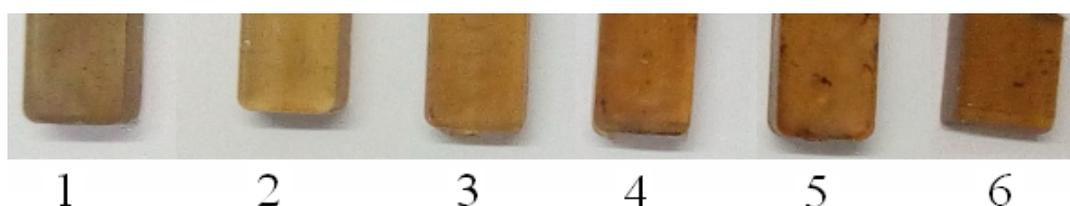
Рисунок 8 – Снимки отлитых образцов ПФСн (1) и ПФСн с различным содержанием ОФСн: 5 % (2), 10 % (3), 20 % (4), 30 % (5), 40 % (6)
