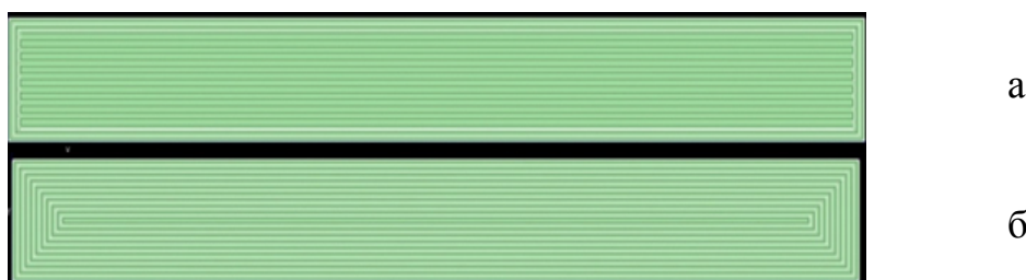
Рисунок 5 – Графическое изображение продольной укладки растров: а – режим внутренней штриховки; б – контурный режим
