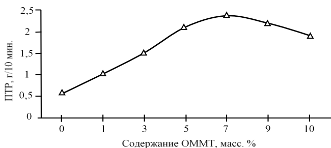
Рис. 17. Зависимость показателя текучести расплава от количества вводимой ОГ
