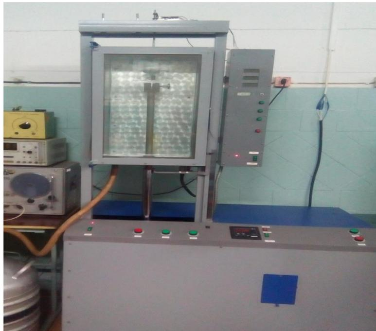
Рисунок 2.10 – Общий вид релаксометра
