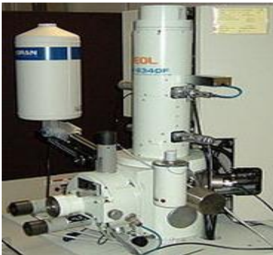
Рисунок 19 – Растровый электронный микроскоп (РЭМ, англ. Scanning Electron Microscope, SEM)
