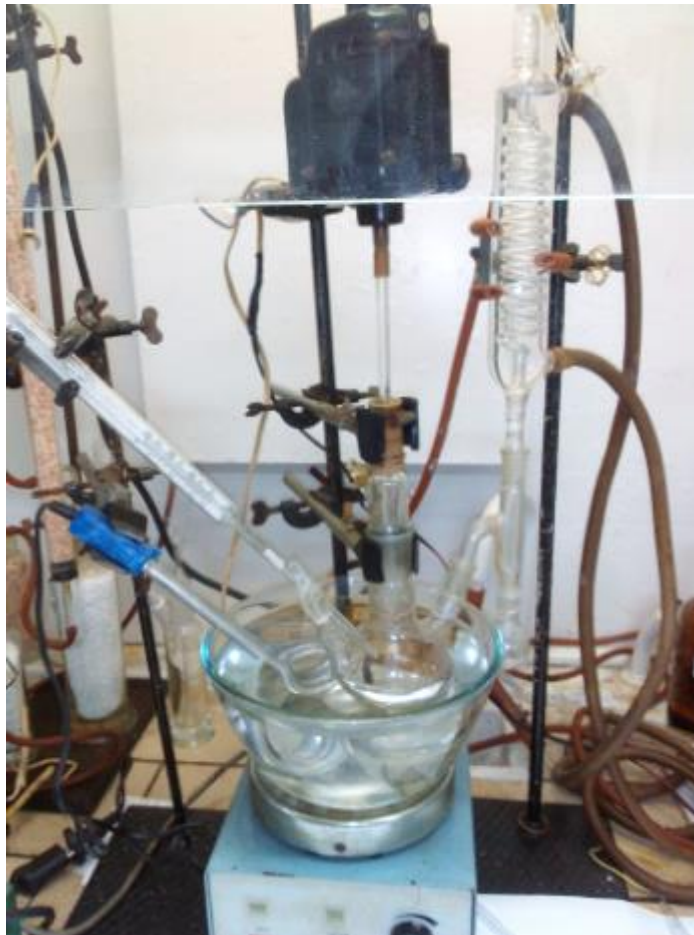
Рисунок 3 - Установка для синтеза полифениленэфкетонпирролформальоксимата
