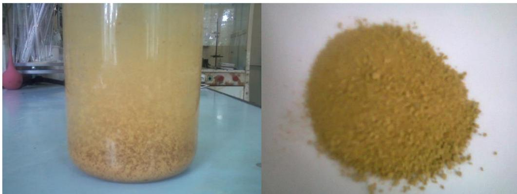
Рисунок 12 – ПФЭКФО, высаженный в воду, и порошок
