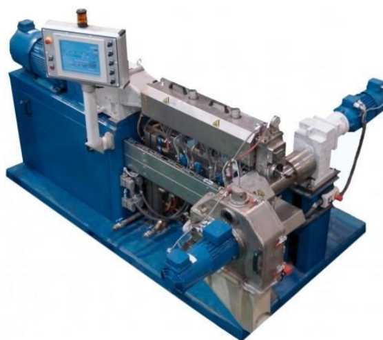
Рис. 2.1. Двухшнековый экструдер Thermo Haake, модель Reomex RTW 25/42
