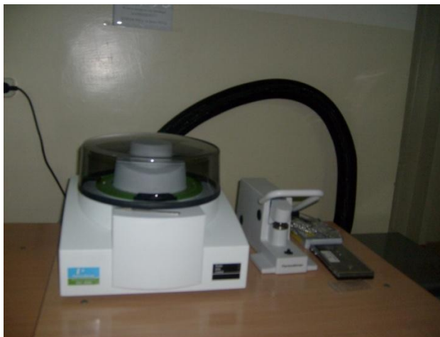
Рис. 2.6. Дифференциальный сканирующий калориметр Perkin Elmer, модель DSC 4000
