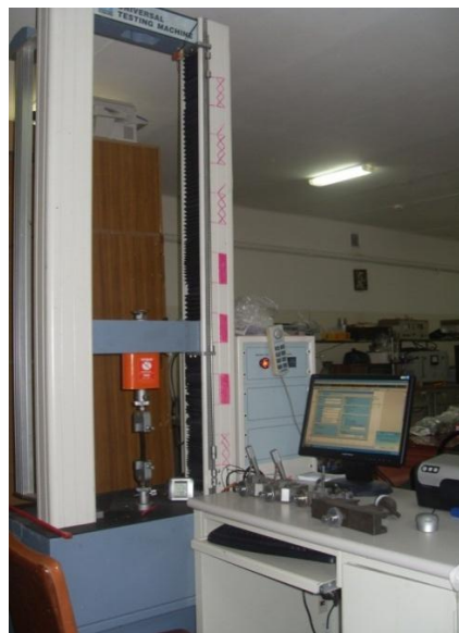
Рис.2.3. Универсальная разрывная машина Gotech Testing Machine СТ-TCS 2000
