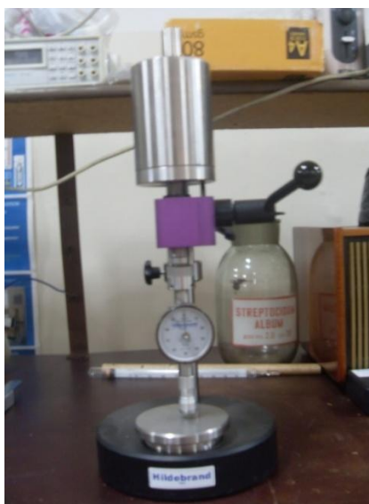
Рис.2.5. Прибор для измерения микротвердости по Шору модели «Hildebrand»
