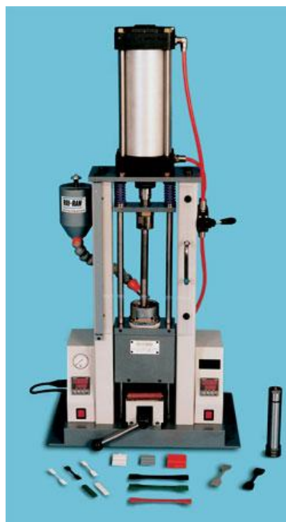
Рис. 2.2. Плунжерно-поршневая литьевая машина марки RR/TSMP/105
