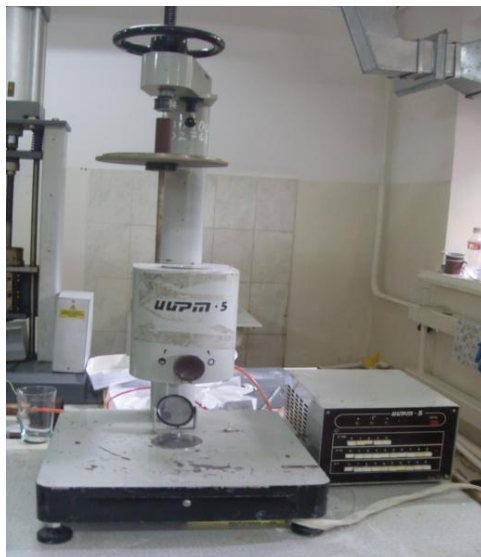
Рис. 2.7. Экструзионный пластометр ИИРТ-5
