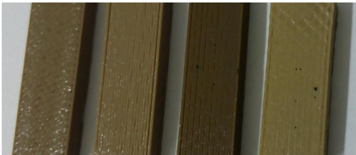
Рисунок 3 – Напечатанные образцы полифениленсульфона синтезированного в ДМСО
