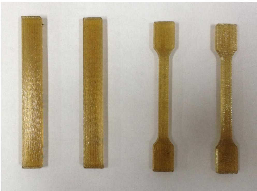
Рисунок 16 – Напечатанные образцы для испытаний из синтезированного ПФСу
