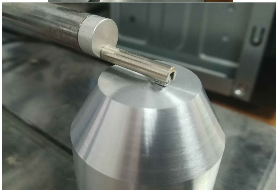
Рисунок 6.12 — Определение шероховатости поверхности цилиндрических образцов: а — профилометр модели 130; б — проведение испытания
