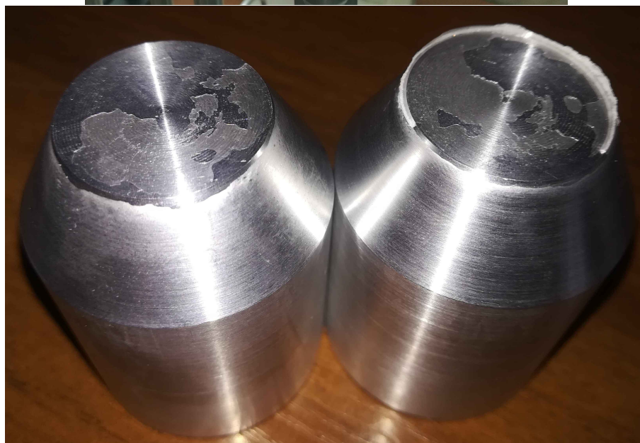
Рисунок 6.16 — Результат проведения эксперимента: уровень нагрузки в момент разрушения, кН (а) и адгезионное разрушение на поверхности алюминиевых образцов (б)
