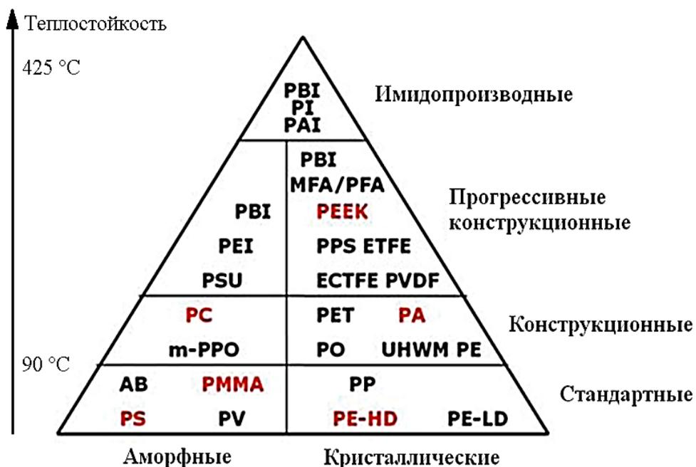
Рисунок 3 – Материалы для селективного лазерного спекания
