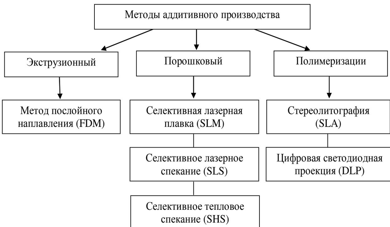
Рисунок 1 – Схематическое изображение методов аддитивного производства
