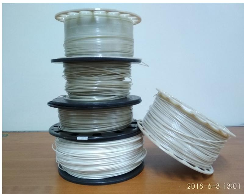
Рисунок 46 – Филамент изготовленный для 3D-печати крупногабаритных изделий
