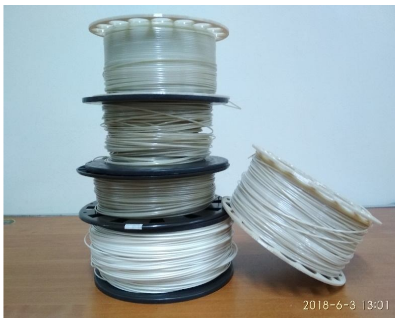
Рисунок 46 – Филамент изготовленный для 3D-печати крупногабаритных изделий
