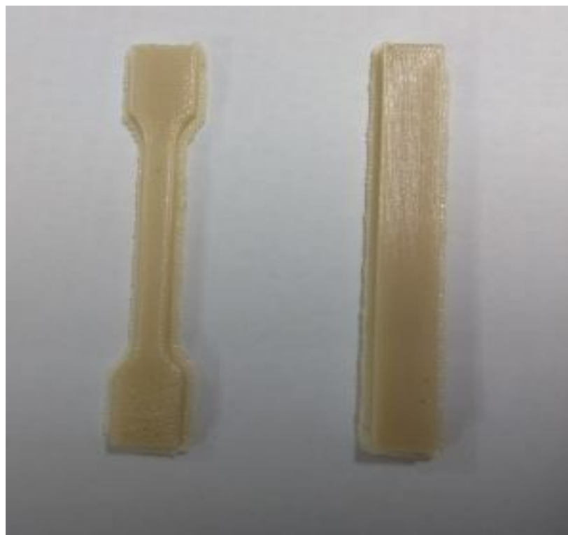
Рисунок 42 – Напечатанные для испытаний стандартизированные образцы
