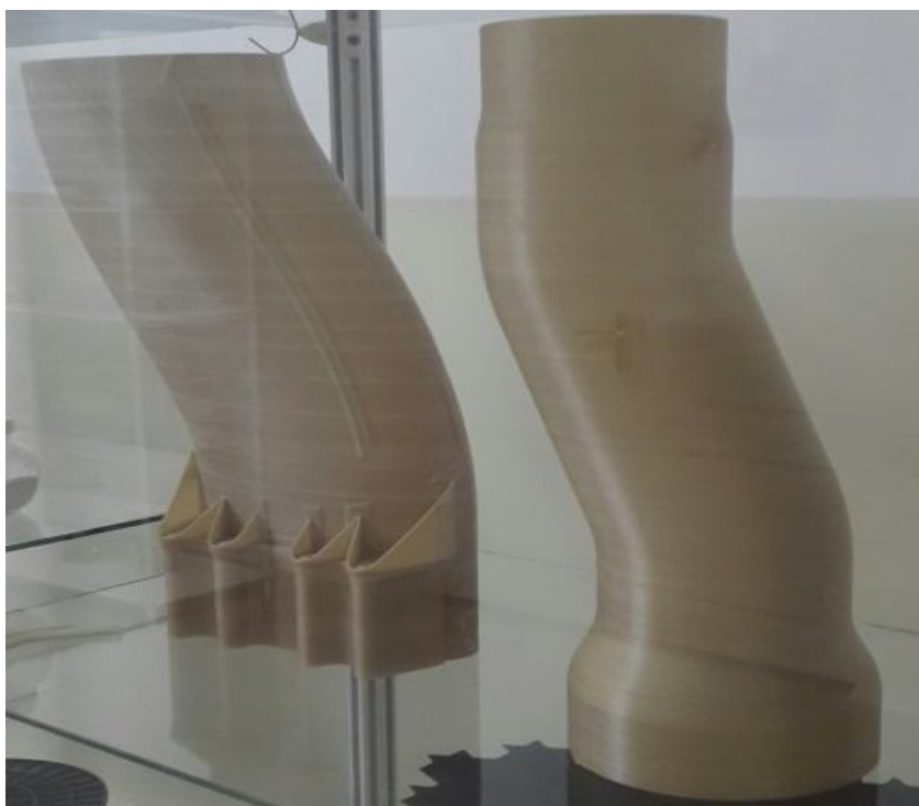
Рисунок 47 – Крупногабаритные сложные тонкостенные воздуховоды, изготовленные из разработанных композитов методом 3D-печати
