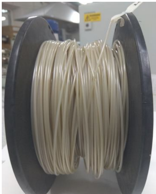
Рисунок 41 – Нить для 3D-печати из композитного материала на основе полифениленсульфона и талька
