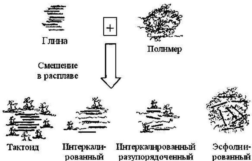
Рис. 1.1. Схематическая иллюстрация терминологии, применяемой при описании структуры нанокомпозитов полимер/органоглина [7].
