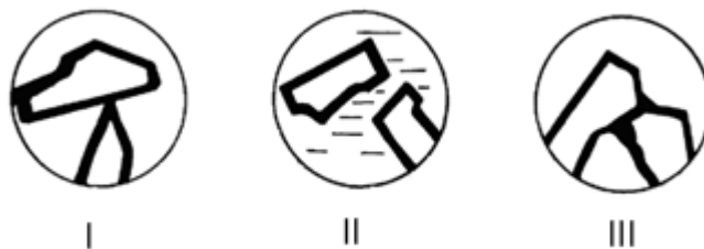
Рисунок 1. Основные типы контактов между частицами твердых дисперсных фаз в концентрированных дисперсных системах: I – атомный контакт; II – коагуляционный контакт; III – фазовый контакт [22]
