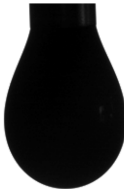
Рисунок 4. Изображение висящей капли суспензии бентонита
