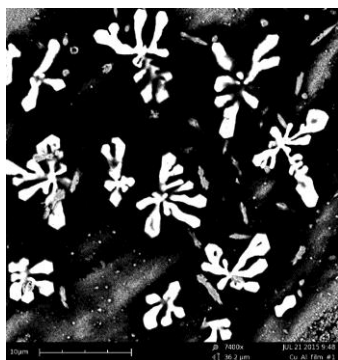
Рисунок 15. Эвтектические фазы на пленке Cu-Al (микроскоп Phenom). Увеличение \times 7400 .
