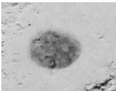
Рисунок 4.11. Внешний вид поверхности диоксида олова после электронного облучения ( $E=1800$  эВ, 5 мкА, в течение 3 час., диаметр пятна соответствует сечению электронного пучка - 0.5 мм).
