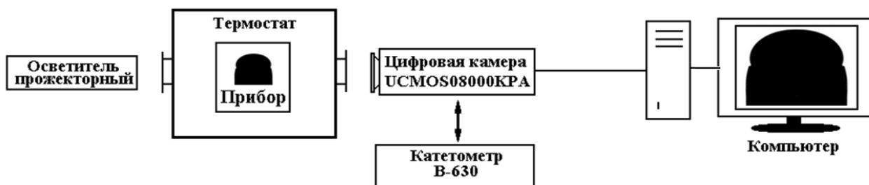
Рисунок 23 – Блок-схема экспериментальной установки для измерения поверхностного натяжения жидких металлов и сплавов методом большой капли
