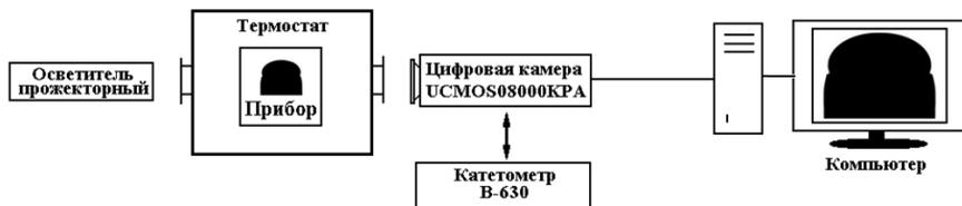
Рисунок 3 – Блок-схема экспериментальной установки для измерения ПН жидких металлов и сплавов методом большой капли
