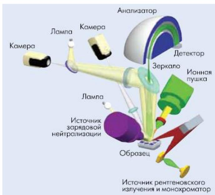
Рисунок 1.10. Геометрия расположения аналитических компонентов системы K- Alpha
