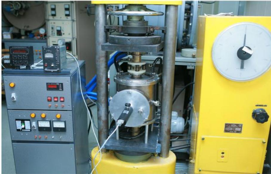
Рисунок 40 – Лабораторная установка искрового плазменного синтеза
